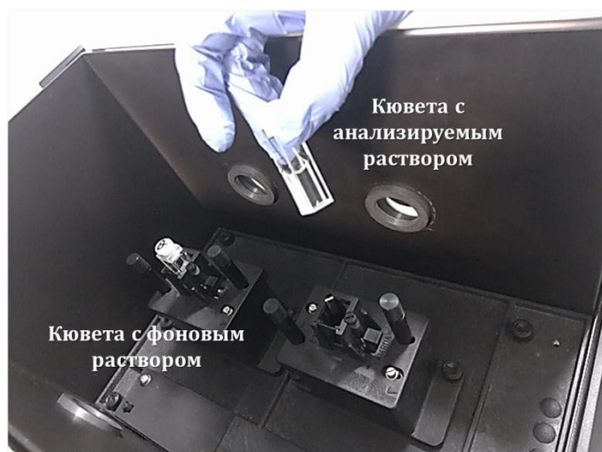
Рисунок 15 – Установка кюветы с анализируемым образцом.
